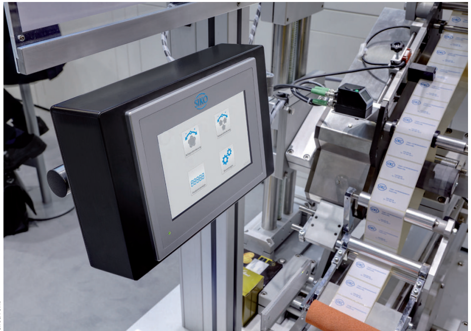
ETC 5000 an einer Etikettiermaschine von BBK
